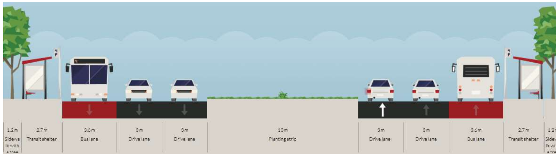
Figure 86 : Coupe de l'hypothèse 1 de l'implantation du site propre
