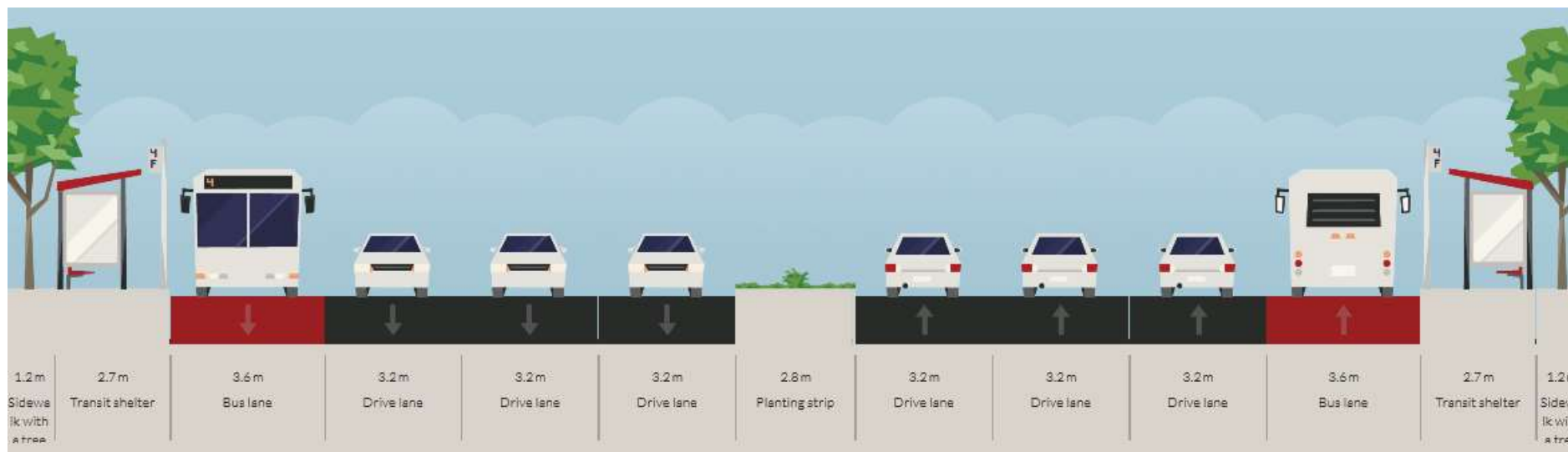
Figure 89 : Coupe de l'hypothèse 2 de l'implantation du site propre
